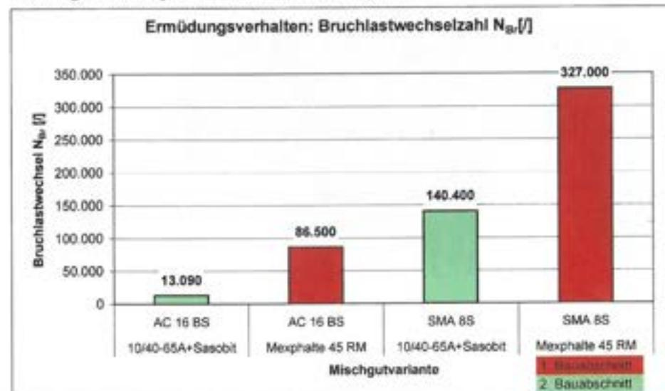
Abbildung 4: Vergleich der Bruchlastwechselzahl der untersuchten Mischgutvarianten beider Bauabschnitte
