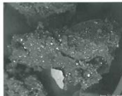
Bild 1: Rasterelektronenmikroskopaufnahme von Gummiteilchen vor der Modifizierung („Urgummiteilchen“)
