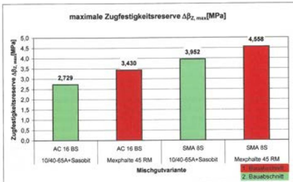
Abbildung 2: Maximale Zugfestigkeitsreserve der untersuchten Mischgutvarianten des 1. und 2. Bauabschnittes
