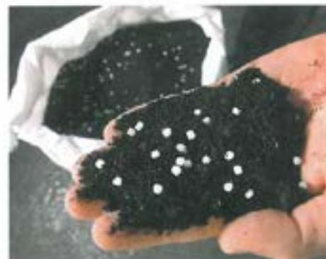
Bild 2: Gummigranulat mit Vestenamer (Quelle Genan)
