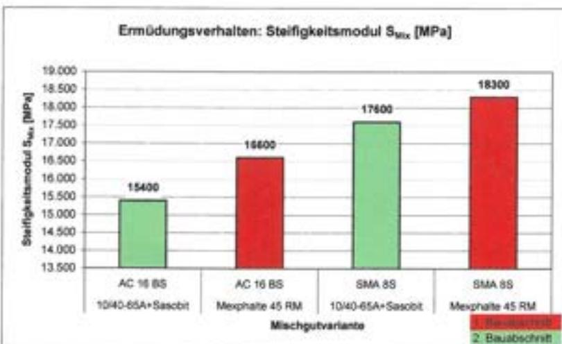
Abbildung 5: Vergleich der Steifigkeitsmodule der untersuchten Mischgutvarianten bei der Bauabschnitte
