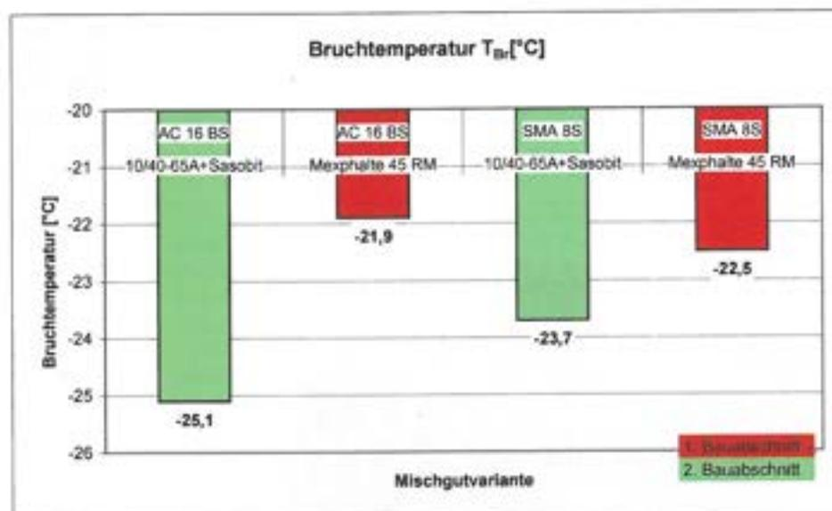
Abbildung 3: Bruchtemperatur der untersuchten Mischgutvarianten des 1. und 2. Bauabschnittes
