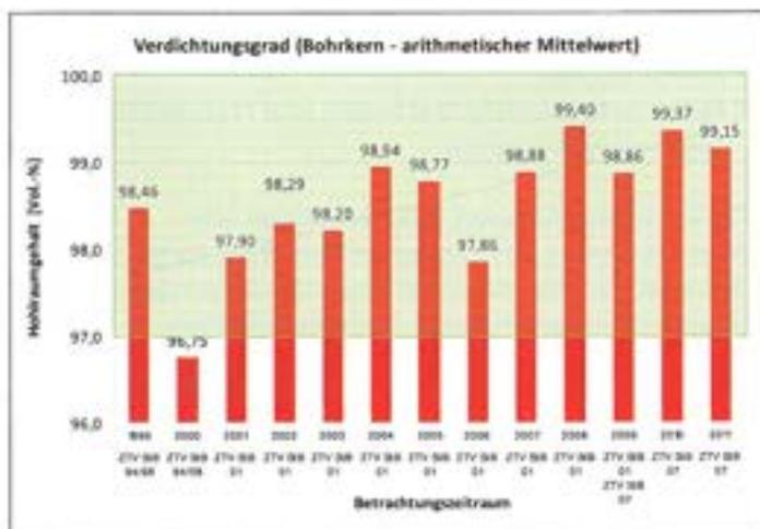
Abbildung 9: Jahresmittelwerte des Verdichtungsgrades am Bohrkern im SMA 0/8S-Mischgut
