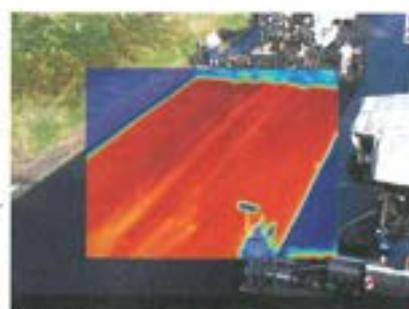
Gleichmäßige Temperatur im Asphaltmischgut hinter der Fertigerbohle.
