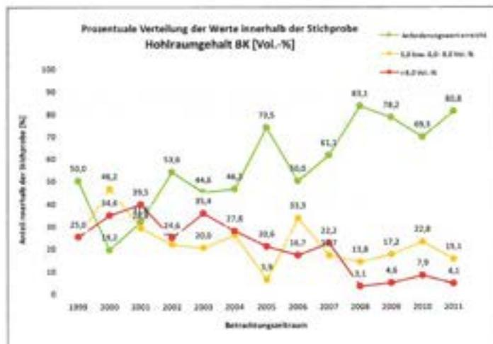
Abbildung 8: Prozentuale Verteilung der Einzelwerte des Hohlraumgehaltes am Bohrkern im SMA 8 S Mischgut
