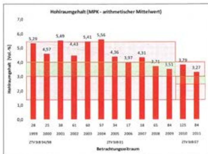
Abbildung 5: Jahresmittelwerte des Hohlraumgehaltes am Marshallprobekörper im SMA 8 S-Mischgut
